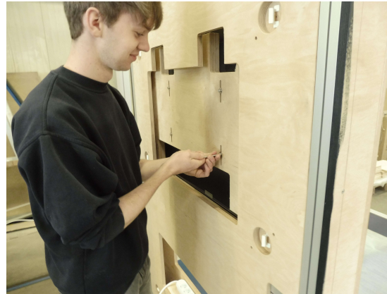
Monitore einsetzen und von hinten verschrauben Insert monitors and screw on from behind
